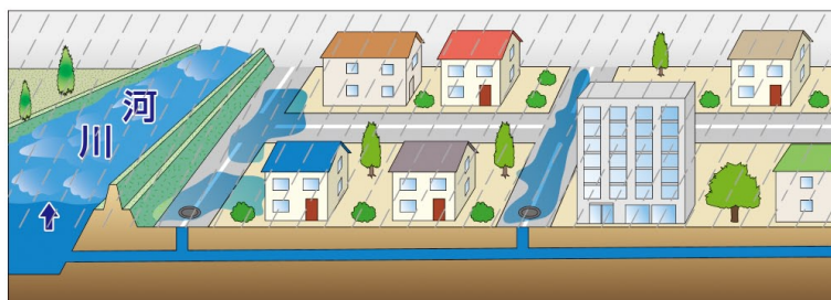
想定外雨量・河川からの逆流・雨水排水能力不足による冠水
