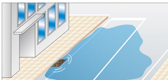
側溝や雨水ますにごみや落ち葉が詰まることによる冠水
