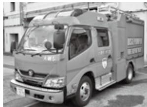
昨年12月に、消防署・本署の消防車を新しく配備しました。この消防車は、少ない水でも効率よく消火活動ができるよう、消火薬剤混合装置を導入しました。また、緊急消防援助隊として、出動する車両として登録しています。
