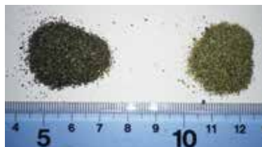
図3 分離後の砂 (左: 磁石についた砂、右: 磁石につかない砂)
