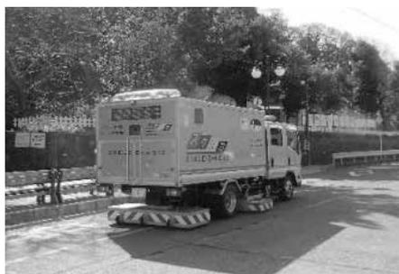
路面下空洞探査車
