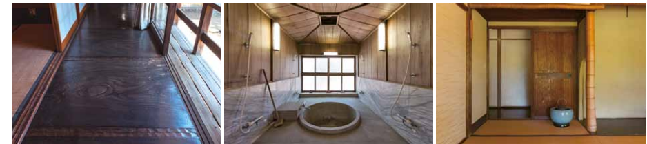
⑥ 檜の一枚板で張られた中廊下。⑦ 伊豆石で作られた特徴のある⑧ 神代杉の戸板と竹の床柱。
